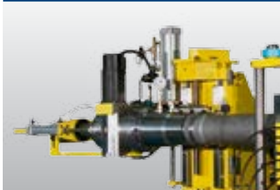
可以让顶缴系统中的剩余管长减到最小
